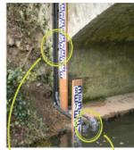
Echelles métriques mesure du niveau d'eau
